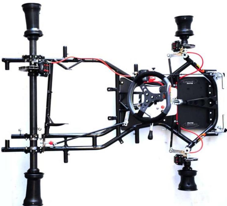
PHOTO VUE DE DESSUS DU CHÂSSIS COMPLET IDENTIQUE À L'UN DES MODÈLES PRÉSENTÉS À L'HOMOLOGATION SANS PARE-CHOCS, CARROSSERIE, SIEGE, NI PNEUMATIQUES
